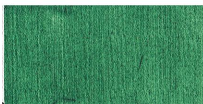
Měděnka vzniklá na plechu, který byl potřen solí a byl vystaven octovým parám
