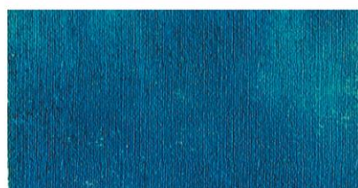
Měděnka vzniklá působením octové par s močí na měděný plech
