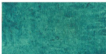
Měděnka vzniklá působením octových par
