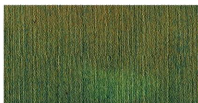
Měděnka vzniklá na měděném plechu potřeném solí a medem, který byl vystaven octovým parám
