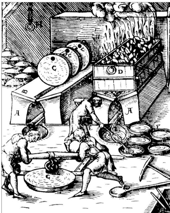
Likvační pec na extrakci olovnaté slitiny s vysokým obsahem stříbra (C. likvační koláče). Vyobrazení podle Lazara Eckera, 1574.
